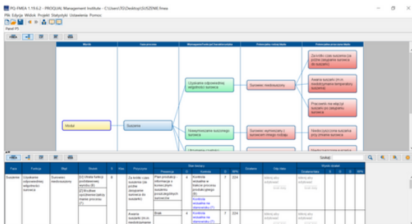
Rys. 2. Fragment FMEA oparty na diagramie drzewa (program PQ-FMEA, www.pq-fmea.pl )
